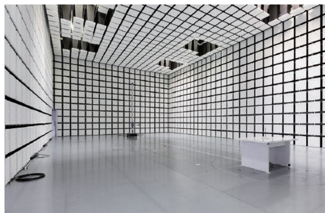
EMCエリアの試験設備例 10m法電波暗室 10 m method radio wave darkroom (EMC test area)
