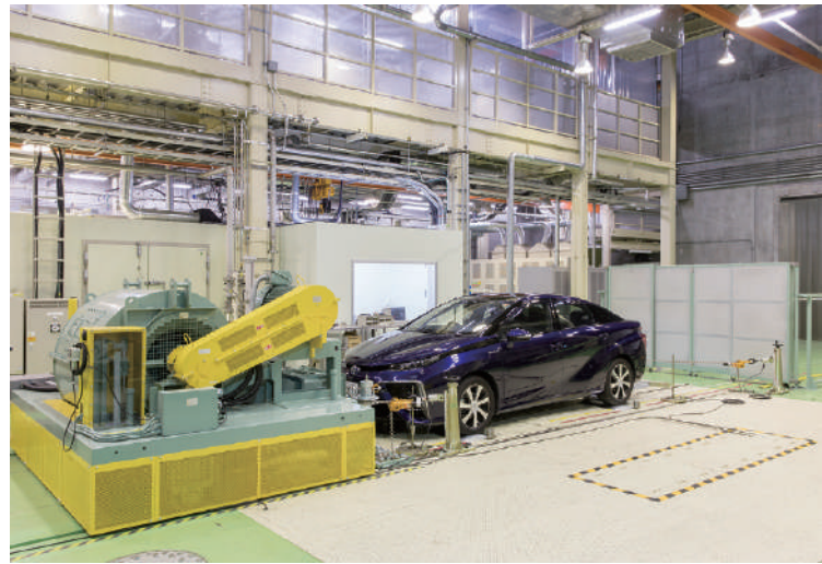
4WDシャシダイナモメータ上でのFCV性能試験 FCV performance test on 4WD chassis dynamometer
