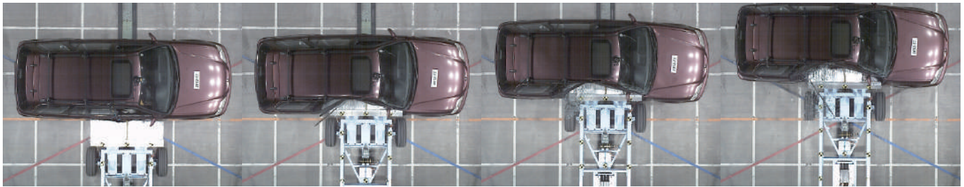
ムービングデフォルマブルバリアによる側面衝突試験 Side collision test using moving deformable barrier
