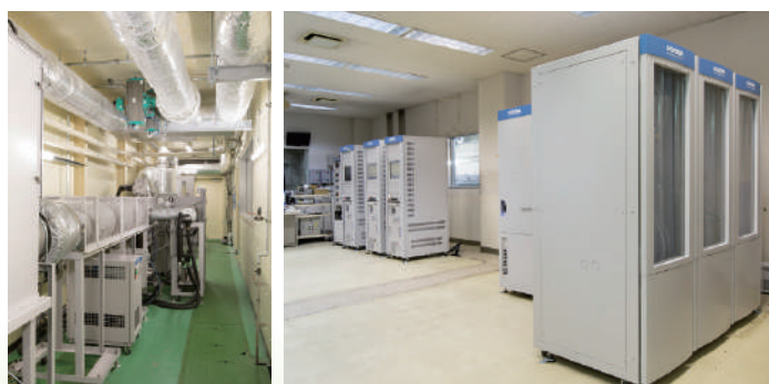
環境型 乗用車用シャシダイナモメータを用いた排出ガス等性能評価システム(環境雰囲気温度可変機能および日射装置を装備 WLTP対応型) Performance evaluation system for exhaust gas, etc. using chassis dynamometer for passenger cars (WLTP compatible variable-temperature chassis dynamometer system with solar simulation device)
