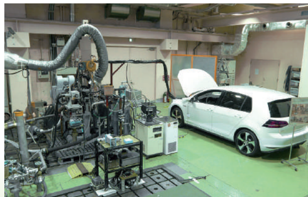
エンジンダイナモメータを用いたエンジン性能評価システム Engine performance evaluation system using engine dynamometer
