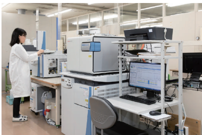
安定同位体比質量分析計を用いた大気汚染物質の評価研究 Evaluation study on air pollutants using stable isotope ratio mass spectrometer
