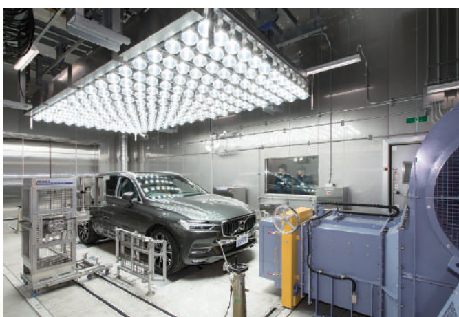
環境型 乗用車用シャシダイナモメータを用いた排出ガス等性能評価システム(環境雰囲気温度可変機能および日射装置を装備 WLTP対応型) Performance evaluation system for exhaust gas, etc. using chassis dynamometer for passenger cars (WLTP compatible variable-temperature chassis dynamometer system with solar simulation device)
