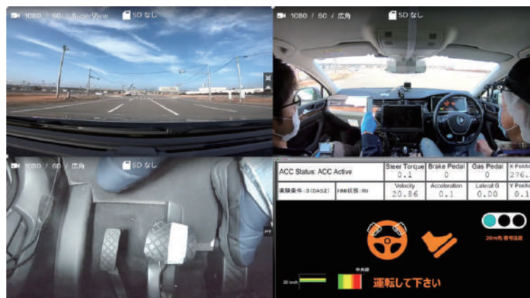
自動運転実験車を用いた運転引継ぎシーンの再現実験 Reproduction test of driving takeover situation using automated driving test vehicle
