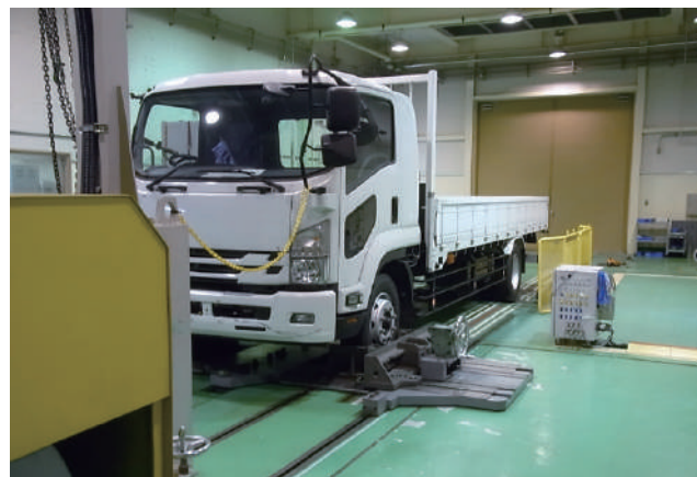
大型シャシダイナモメータを用いた排出ガス等性能評価システム Performance evaluation system for exhaust gases, etc. using heavy-duty vehicle chassis dynamometer
