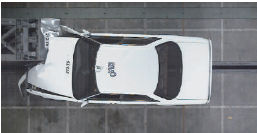
デフォルマブルバリアへの前面オフセット衝突試験 Frontal offset collision test on deformable barrier
