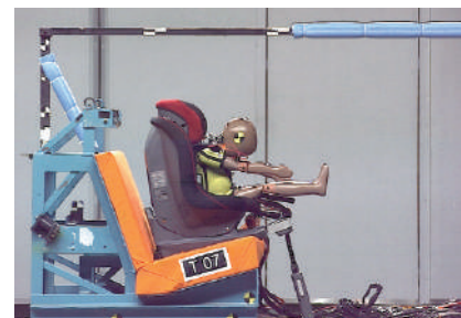
チャイルドシートの性能評価試験 Evaluation test of child restraint systems
