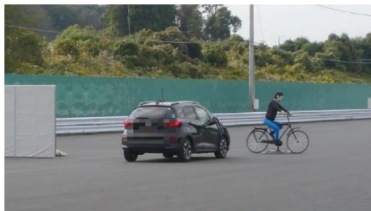
衝突被害軽減ブレーキ(対自転車)試験 Evaluation test of autonomous emergency braking (bicycle)
