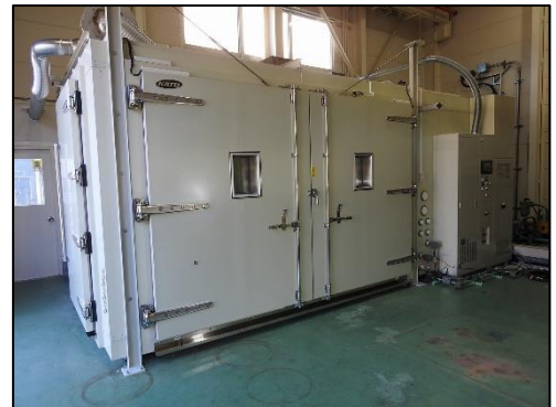
大型恒温恒湿槽 (大型・大容量容器にも対応可能)
