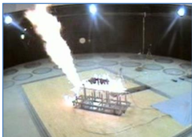
圧縮水素ガス容器の火災暴露試験
