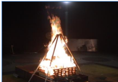
木材ク립による火災暴露試験
