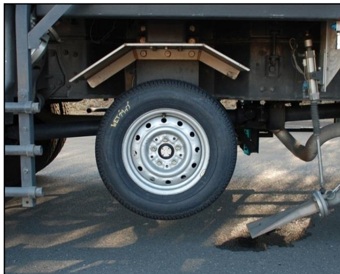
路上タイヤ試験車測定輪 (右前輪と右後輪の間に装備)
