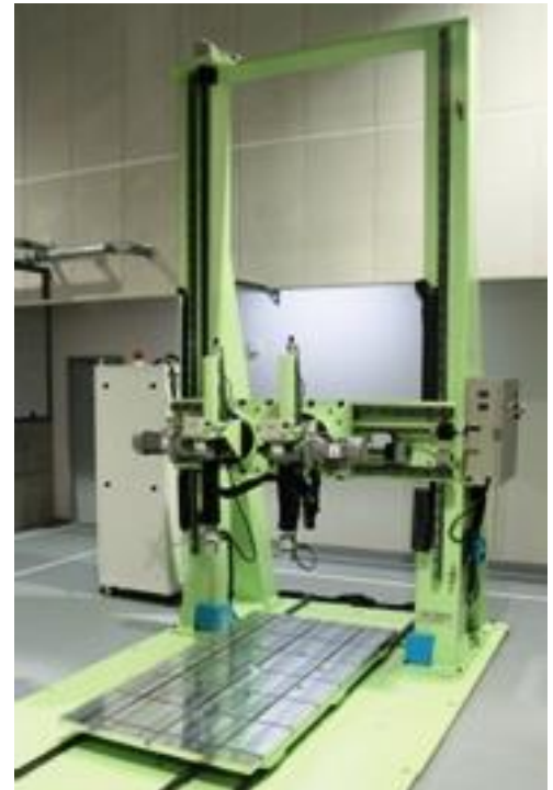
耐荷重試験装置
