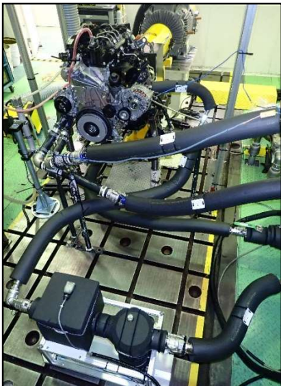
エンジン据付け状況 (一例)
