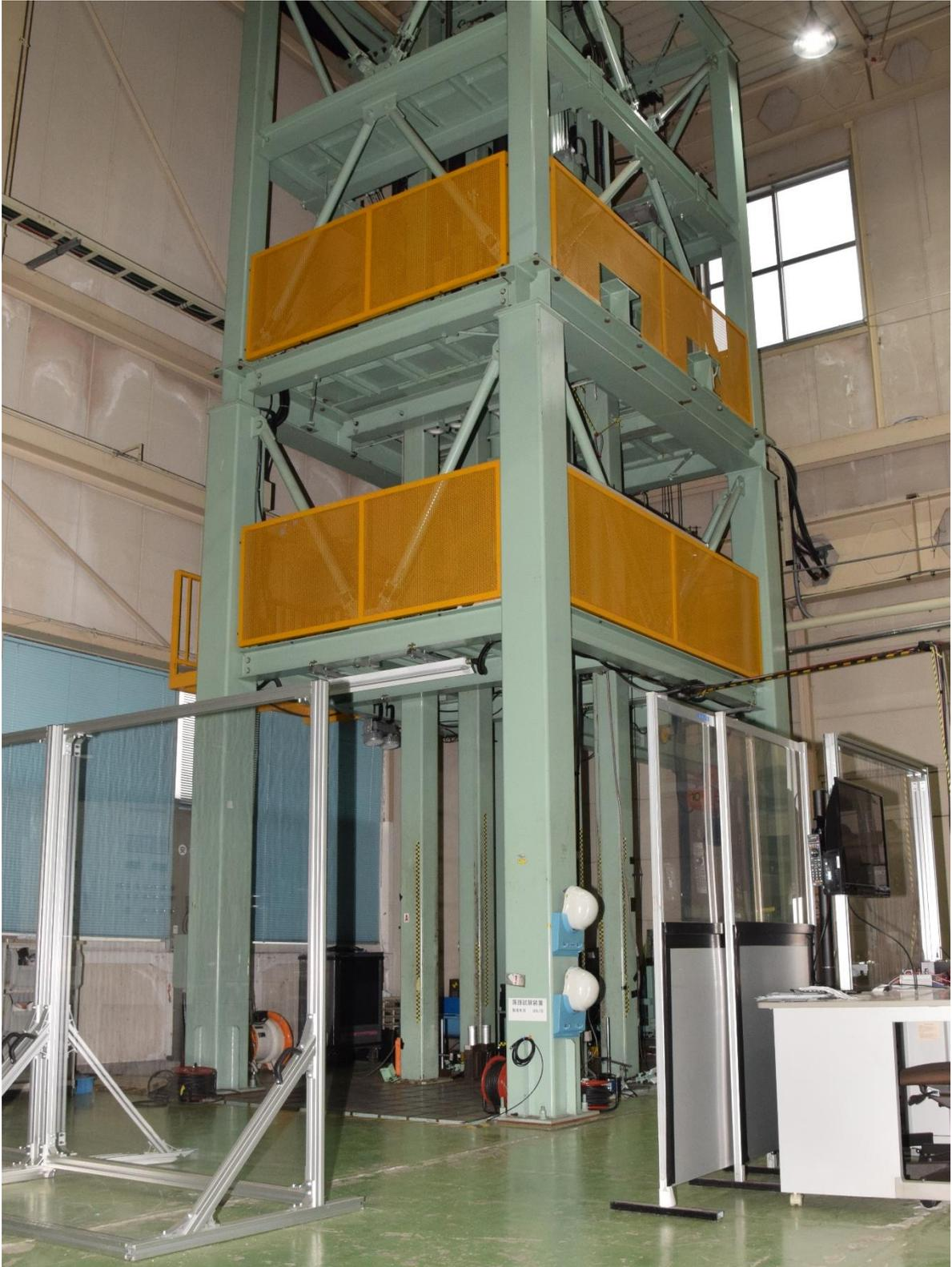
重さ65kg ~ 2,000kgの錘体を最大7,000mmの高さから垂直に落下させ、定盤上に設置した試験体に動的な圧縮負荷を与える試験です。錘体負荷面に各種アタッチメントを取り付けることにより、斜め負荷や局所負荷などの様々な負荷条件（要相談）を設定することが可能です。また、錘体ストッパーにより試験体の潰れ量を調整できます。
