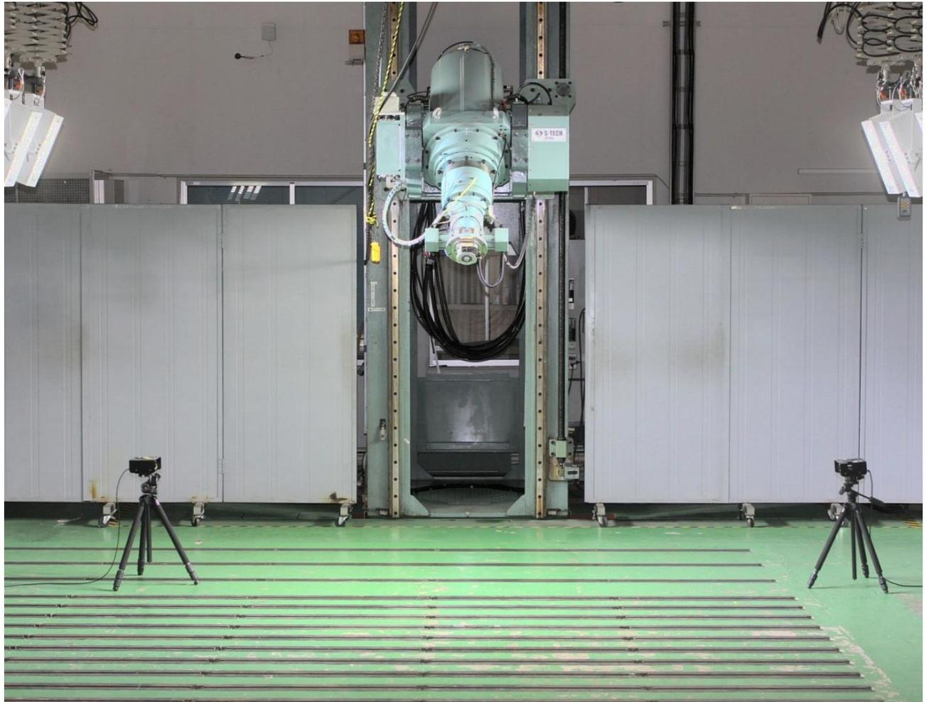
圧縮空気を使用したシリンダーにより人体の一部を模擬したインパクター（衝撃子）を射出し、フリーフライト状態で対象物に衝突させ、インパクターに取付けたセンサーにより対象物から受ける衝撃度合いを評価する試験です。
