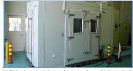
環境試験用加圧装置と組み合わせることで,低温から高温環境下において供試品を加減圧(最大120MPa)する圧力サイクル試験や,一定圧力で一定期間保持する加速応力試験を実施することが可能
