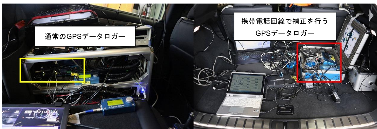
図2 実験車両に計装したGPSデータロガー
