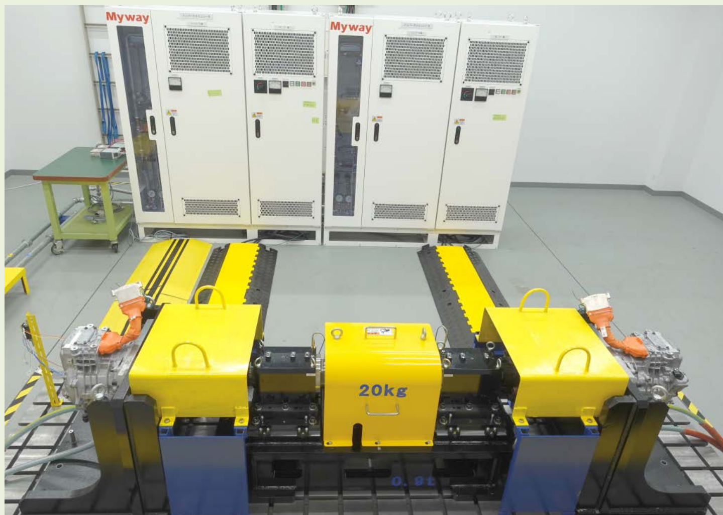
モータを設置した中間軸システムとインバータエミュレータ
