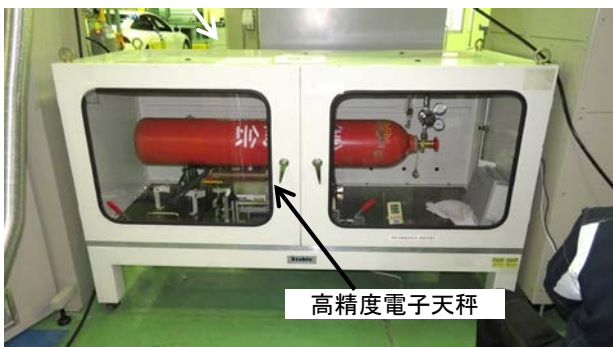
トータル燃費測定 (質量法用精密天秤)
