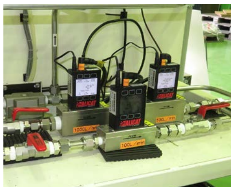
瞬時燃費測定 (流量法用流量計)
