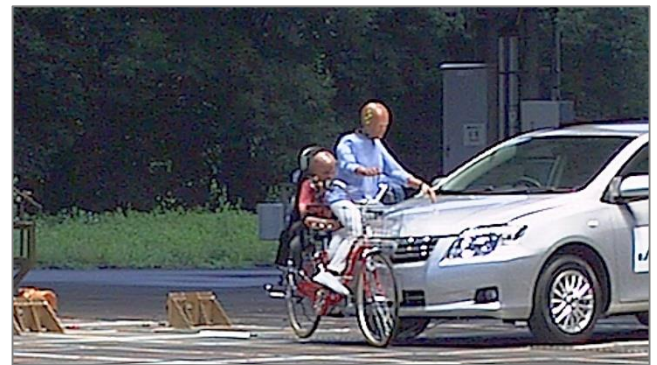
車対自転車衝突試験
