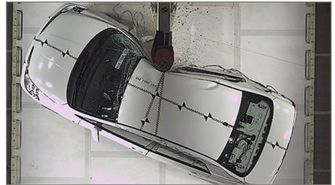
対ポールバリア側面衝突試験
