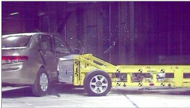
MDB側面衝突試験
