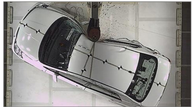
対ポールバリア側面衝突試験
