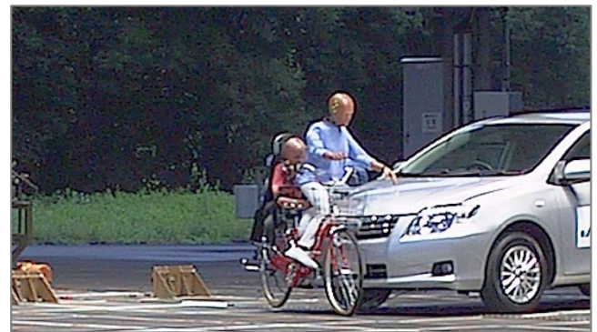
車対自転車衝突試験
