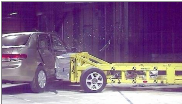
MDB側面衝突試験
