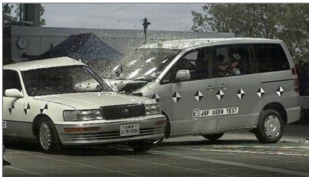
車対車側面衝突試験
