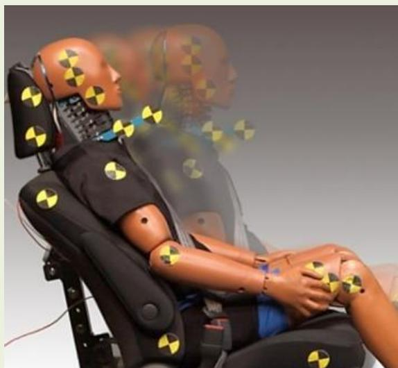
後面衝突時頸部保護性能評価試験
