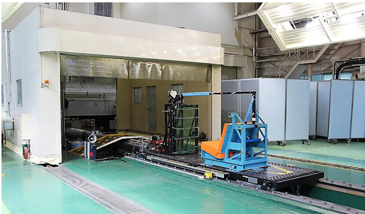
レール上を水平に移動可能なスレッド（台車）に試験体を搭載し、高圧ガスを使用したピストンでスレッドを水平方向に打ち出して急激な加速度を与えることで、実際の衝突現象において試験体が受ける衝撃度合いを簡易的に再現する試験です。
