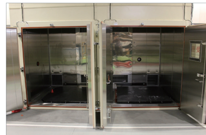
強度エリアの試験設備例 複合環境試験機 Combined climatic and dynamic test equipment (Mechanical test area)
