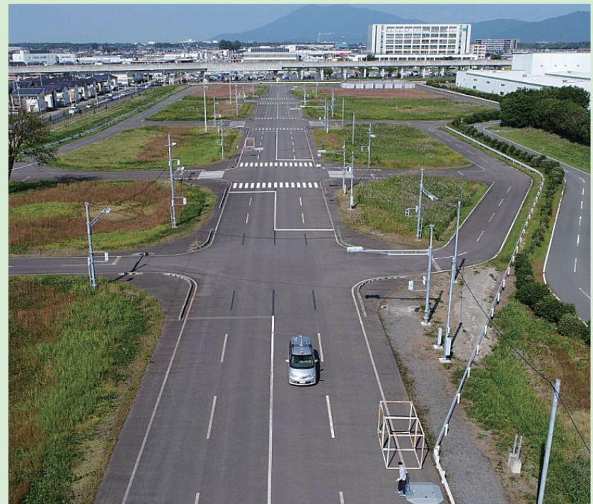
V2X市街地における混合交通環境の再現例 Example of reconstruction of mixed traffic situation in V2X urban area
