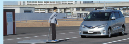
多目的市街地における歩行者横断シーンの再現例 Example of reconstruction of pedestrian crossing scene in versatile urban area
