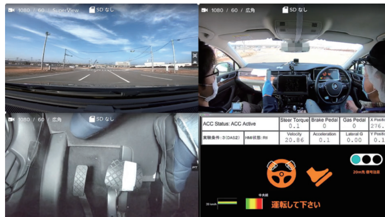
自動運転実験車を用いた運転引き継ぎシーンの再現実験 Reproduction test of driving takeover situation using automated driving test vehicle
