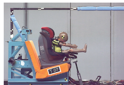
チャイルドシートの性能評価試験 Evaluation test of child restraint systems
