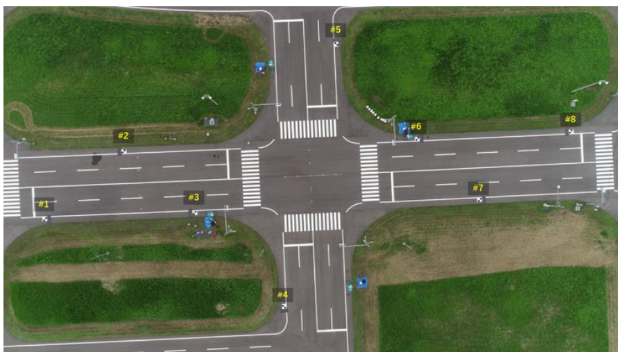
Fig. 6 ドローン空撮による定点観測基礎実験を実施したJtown_V2X市街地 （ドローン高度：約100 m, #1～#8はオルソ変換用参照点）
