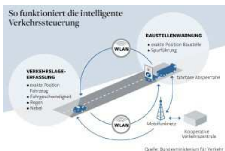
図 2.1.1-10 Cooperative ITS Corridor の初期アプリのアーキテクチャ (出典: Road Map AG)
