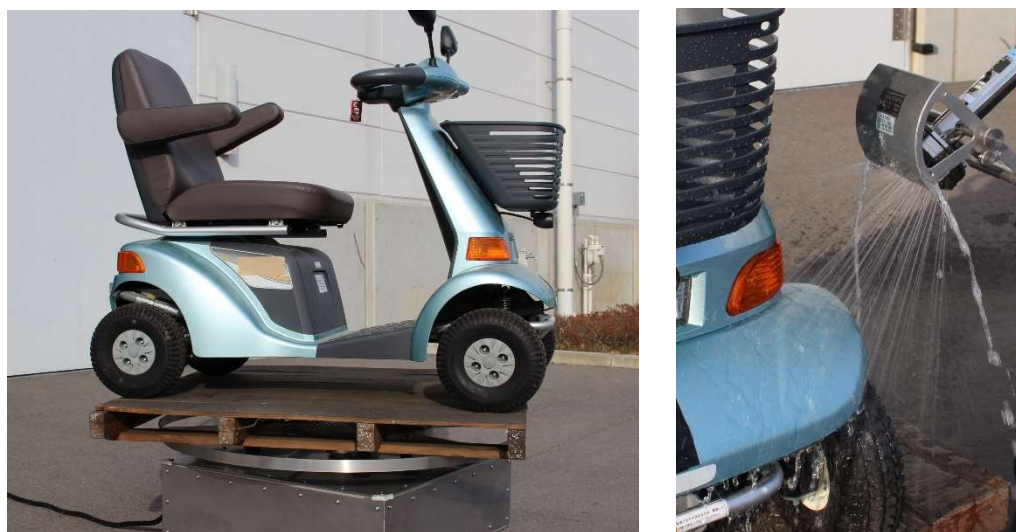
防滴試験設備 (IPX3, IPX4が実施可能)
