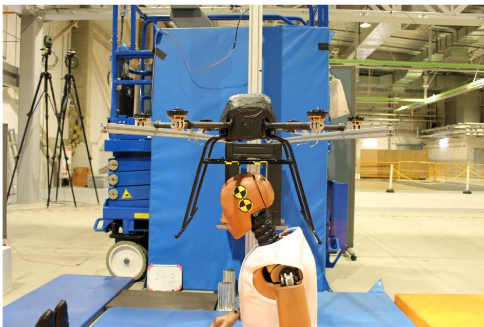
無人航空機 垂直落下試験装置
