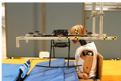
無人航空機 水平衝突試験装置（人体ダミー以外に衝突させることもできます）
