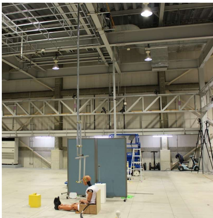
無人航空機 水平衝突試験装置（人体ダミー以外に衝突させることもできます）
