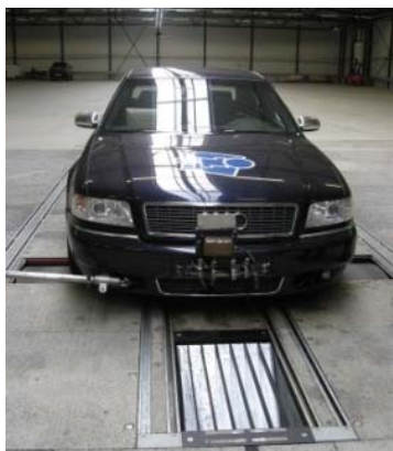
図 19 シャーシダイナモ上の試験車両
