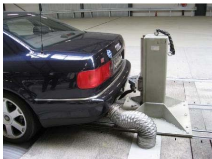
図 19 シャーシダイナモ上の試験車両
