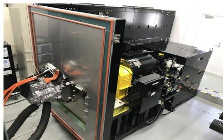
図21 400kW大型モータダイナモメータ
