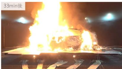
図 17 車両火災時の発熱速度計測
