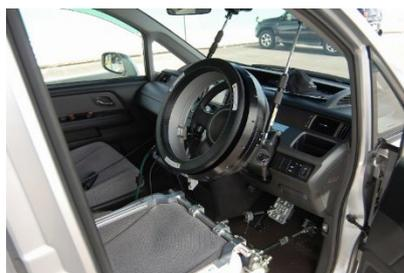
図 52 運転操作ロボット
