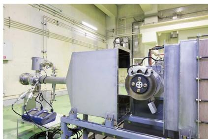
図22 ブレーキ粉塵粉塵試験装置
