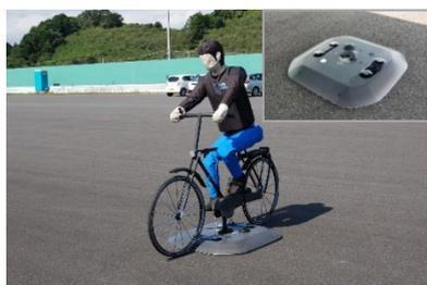
図 50 自律走行型 自転車ターゲット装置
