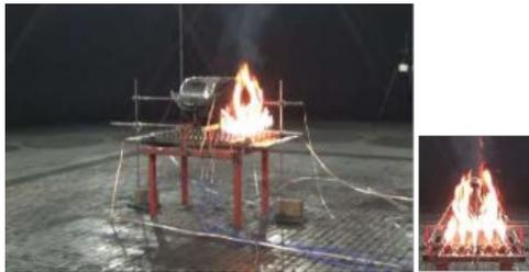
図 15 火災暴露試験法の再現性向上に向けた試験例
