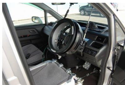
図 51 運転操作ロボット
