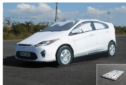
図 50 自律走行型 車両ターゲット装置
