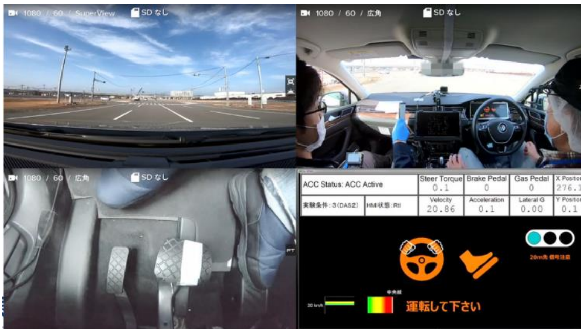
図 41 自動運転実験車を用いた運転引継ぎシーンの再現例
