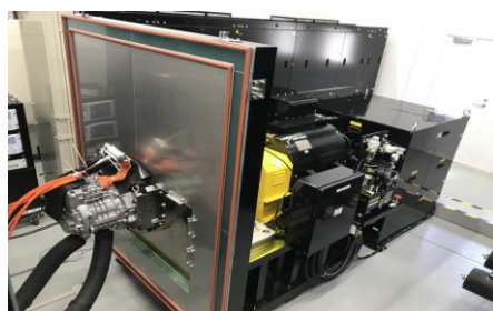
図 21 400 kW 大型モータダイナモメータ
