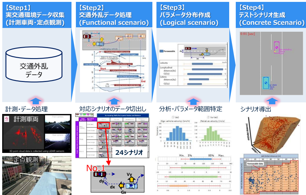
図 38 高速道路における安全性評価シナリオの作成プロセス
