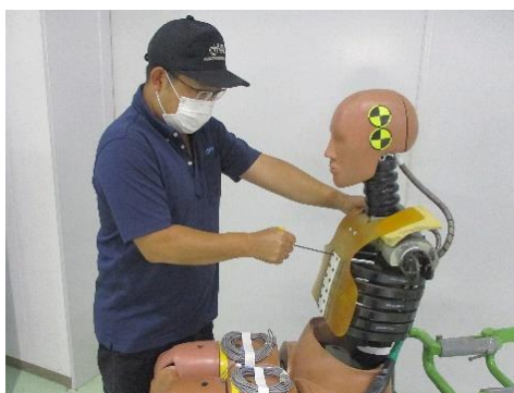
図 36 衝突試験用ダミーの整備
