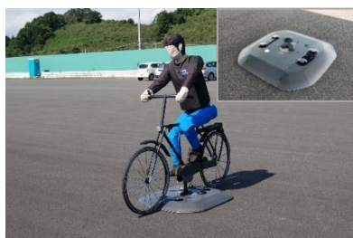
図 49 自律走行型 自転車ターゲット装置
