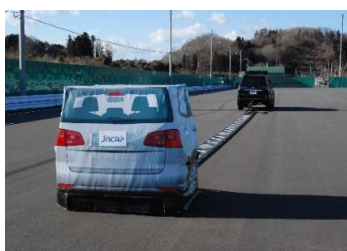
図 47 車両 (CCRm) ターゲット装置
