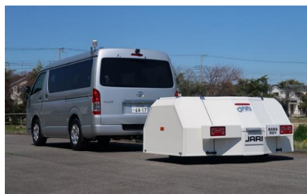
図 23 タイヤ/路面騒音測定装置（CPX トレーラ）
