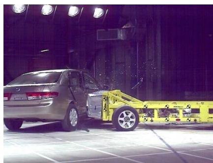
図 34 ムービングバリア側面衝突試験
