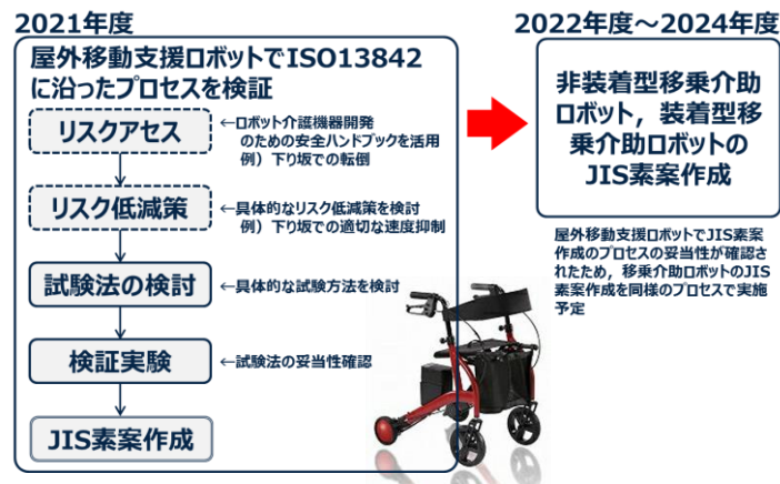
図 39 移動支援型介護ロボットの安全性評価研究プロセス
