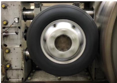
図 54 タイヤの転がり抵抗試験
