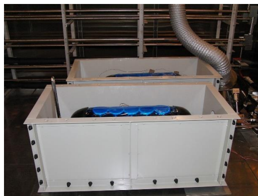
図 25 大型恒温槽を用いた液圧サイクル試験
