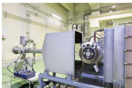
図 22 ブレーキ粉塵粉塵試験装置
