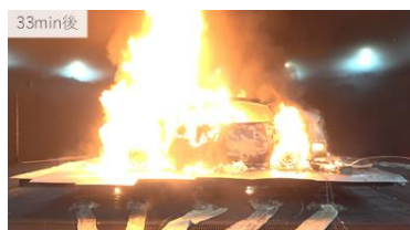
図 17 車両火災時の発熱速度計測
