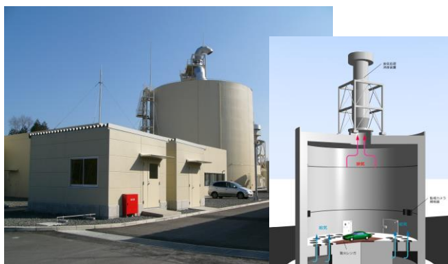
図 24 耐爆火災試験設備
