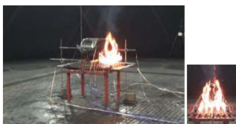
図 15 火炎暴露試験法の再現性向上に向けた試験例
