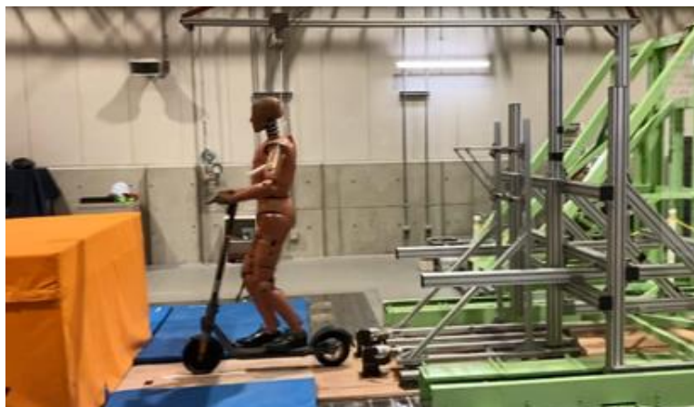
図 58 例. 運転電動キックボードの衝突試験
