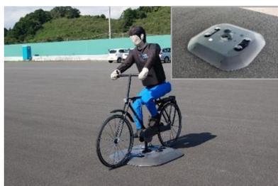
図 49 自律走行型 自転車ターゲット装置
