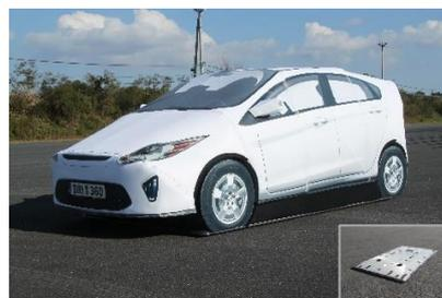
図 50 自律走行型 車両ターゲット装置
