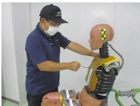
図 36 衝突試験用ダミーの整備
