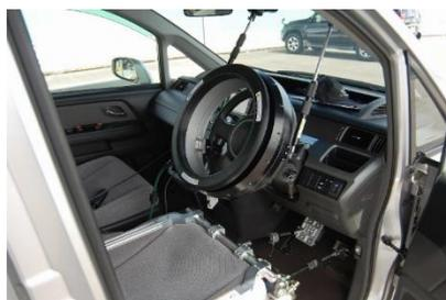
図 51 運転操作ロボット
