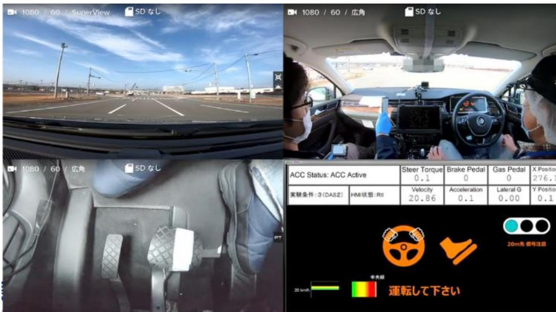
図 41 自動運転実験車を用いた運転引継ぎシーンの再現例
