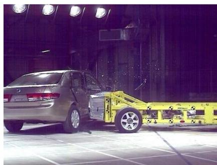
図 34 ムービングバリア側面衝突試験
