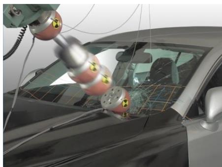
図 35 歩行者頭部保護性能評価試験
