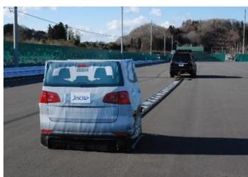
図 47 車両 (CCRm) ターゲット装置
