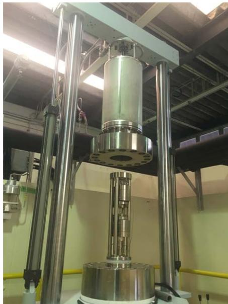
図1 高圧水素ガス環境下での金属材料の耐久性を評価する材料試験装置
