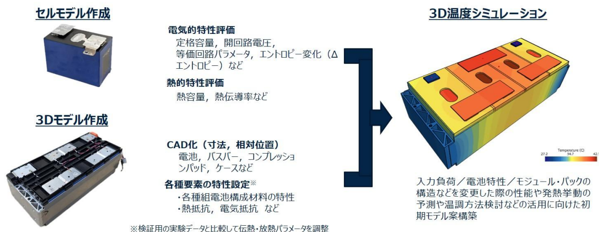
図1 車載用蓄電池の3D温度シミュレーションの概要
