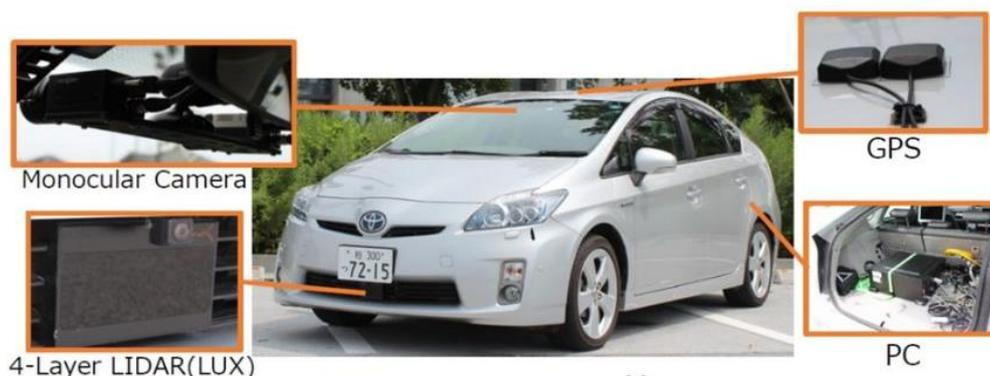
図2 S-イノベの実験車両のセンサ構成
