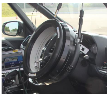
a) ステアリング操作ロボット部
