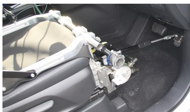
b) アクセル操作ロボット部
