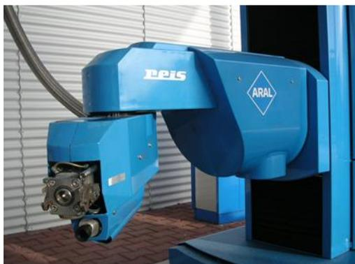
図 5 液体水素の充填ノズル
