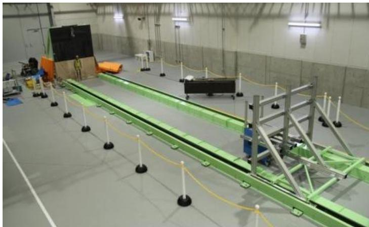
Fig. 3 ロボット用衝突試験システム
