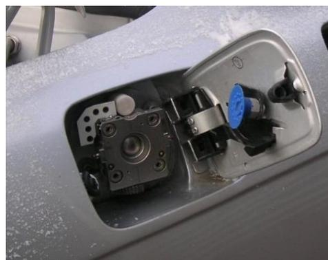
図 6 液体水素の充填レセプタクル
