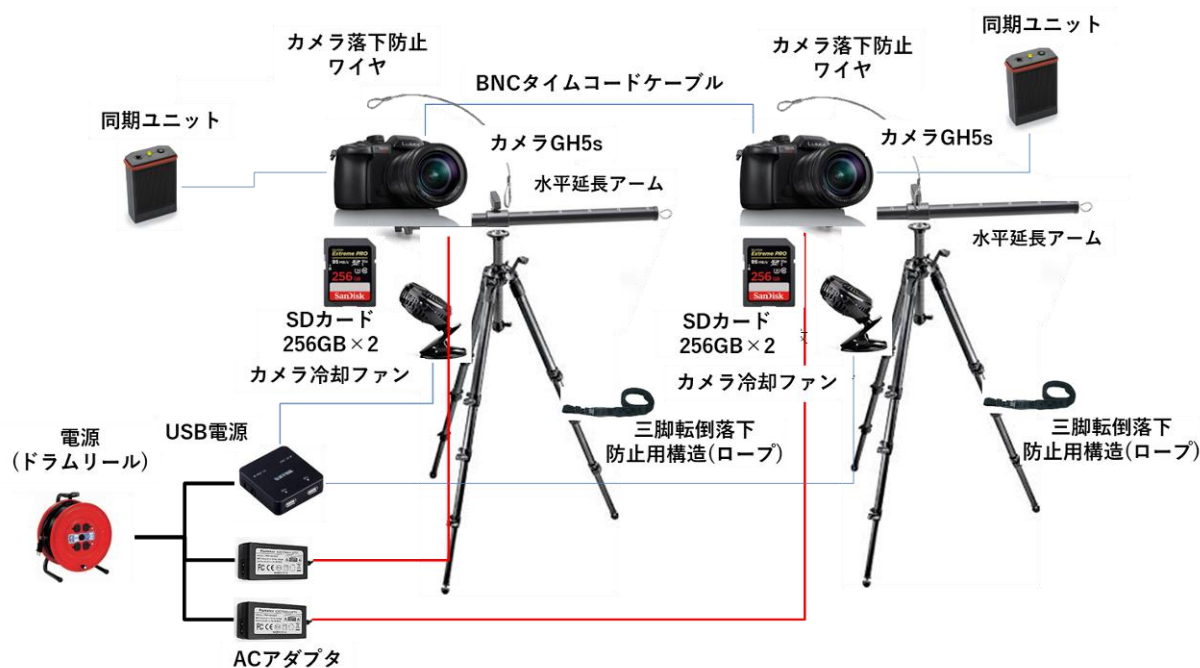
Fig. 3 ミラーレス一眼カメラによる同期保存システム（市販品）（有人屋 8h 程度の撮影）
