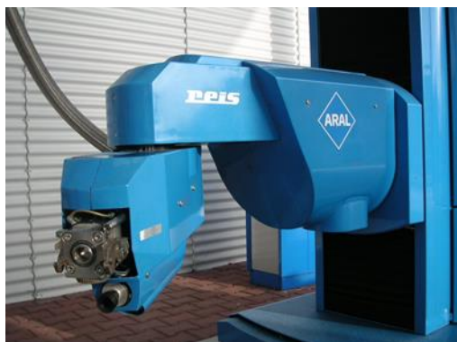
図 5 液体水素の充填ノズル
