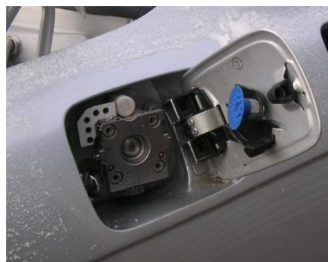
図 6 液体水素の充填レセプタクル
