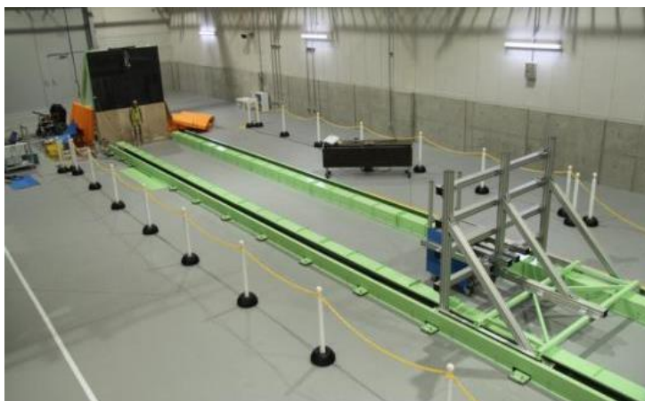
Fig. 3 ロボット用衝突試験システム
