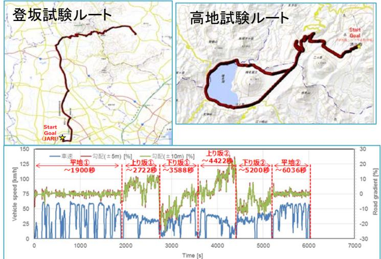
各試験ルートと計測結果一例(車速、勾配)
