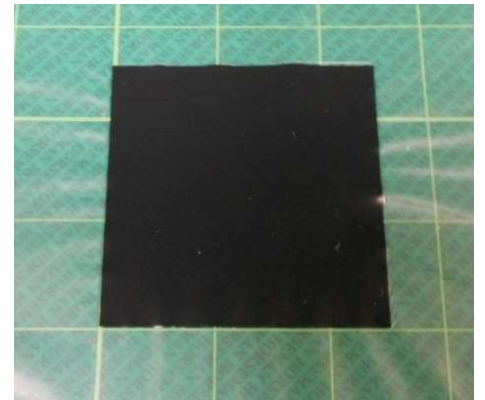
CCM (Pt/C触媒、フッ素系膜で作製)
