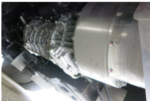
図 6 流体クラッチ付き 6 速 AMT および永久磁石式同期モータ
