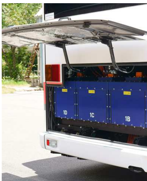
図 4 車両後部に搭載された LIB パック × 4 基
