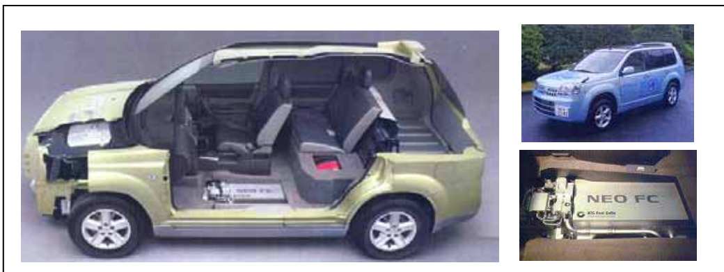
図 4-12. X-TRAIL FCV と搭載されている Series 500 (NEO FC)
