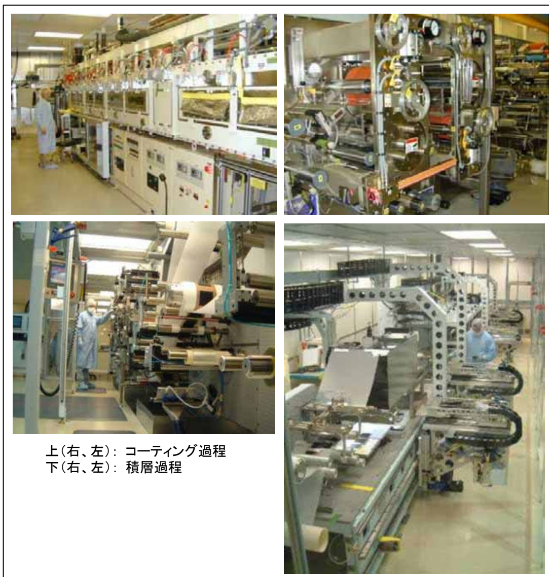
図 7-4. 3M の MEA 生産工場 (ウィスコンシン州)
