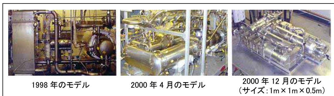
図6-3. ExxonMobilが開発した車載ガソリン改質システム
