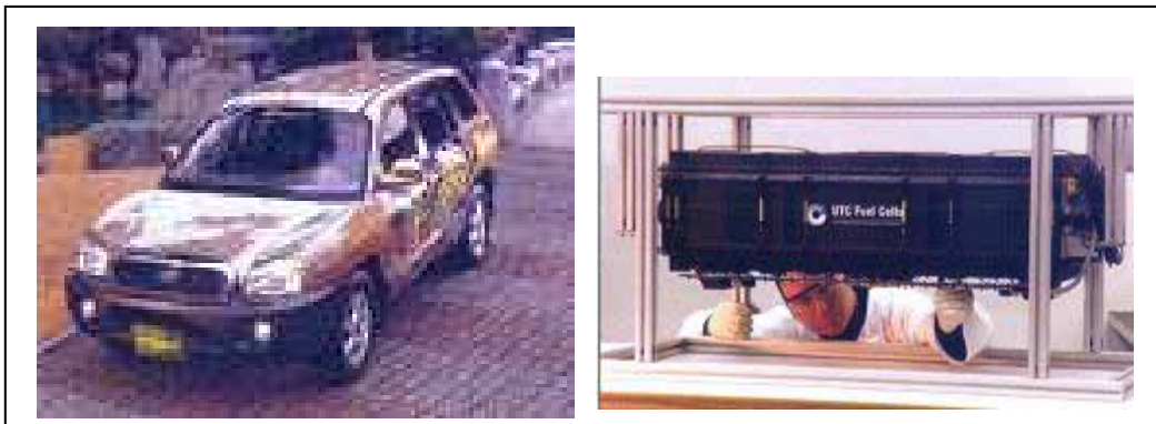
図 4-11. Santa Fe FCEV と搭載されている Series 300
