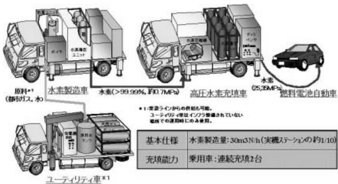
図 3 - 1 移動式都市ガス改質形水素ステーションの構成
