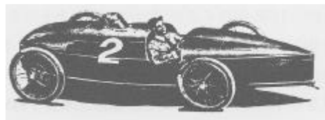
1906年 スタンレー・スチーマー 蒸気2気筒機関150HPで205.3km/h
