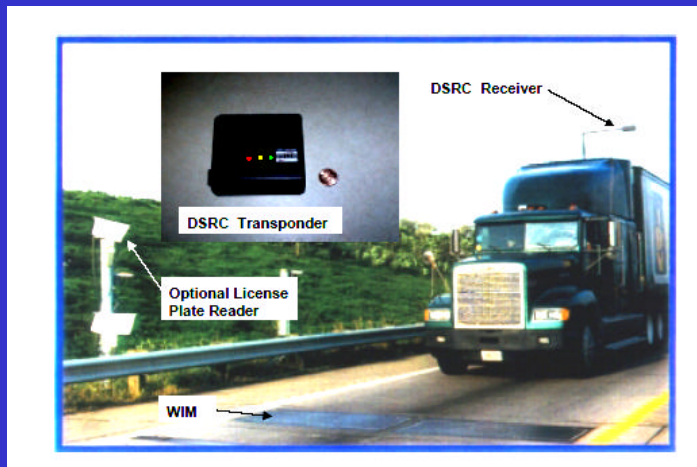
車両 ID、車両重量の自動計測例
