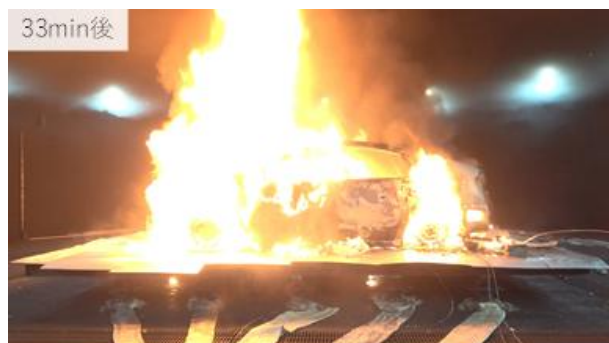
図 19 車両火災時の発熱速度計測
