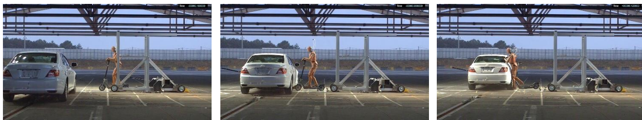
図 33 自動車対電動キックボードの衝突実験
