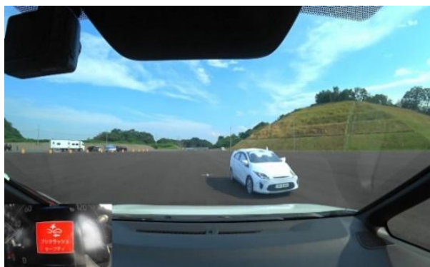
図 35 右直対向車への AEBS 性能調査
