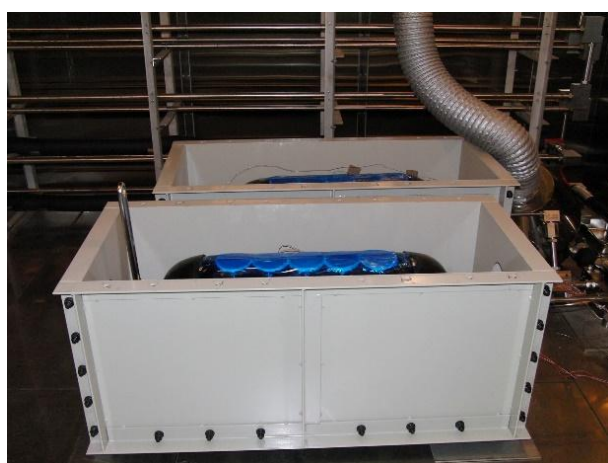
図 27 大型恒温槽を用いた液圧サイクル試験
