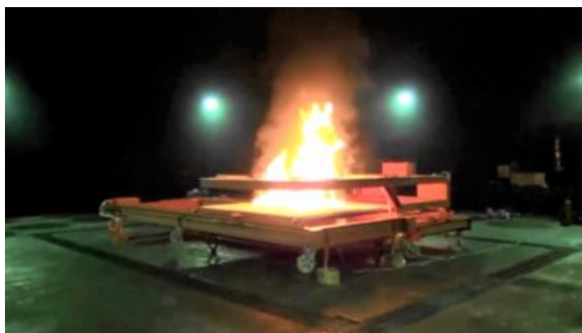
図 29 蓄電池耐火性試験
