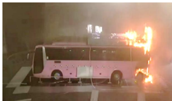
図 201 大型車両火災実験
