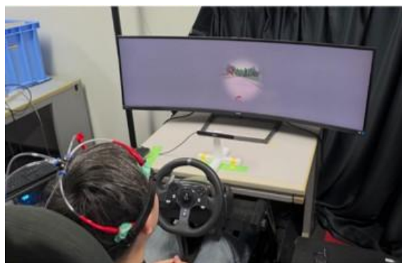
ドライビングシミュレータと自動刺激提示装置の連携
