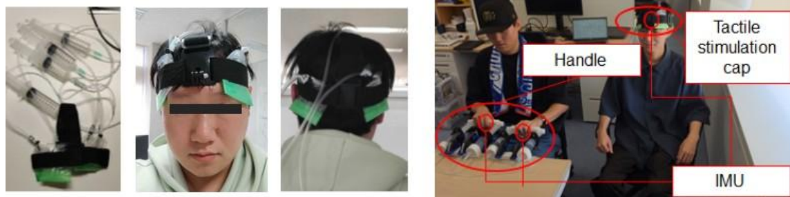
ハンガー反射刺激提示装置のプロトタイプ(左:2024年度、右:2025年度)
