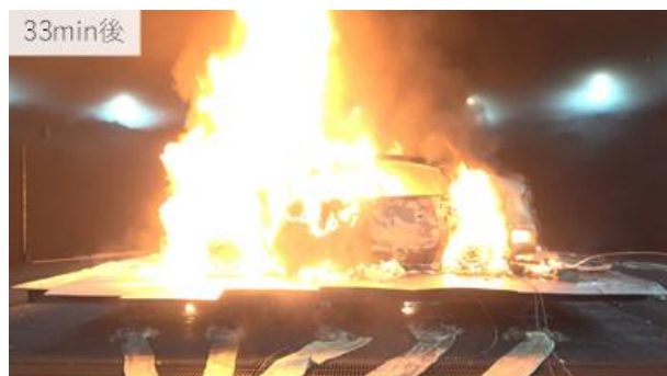
図 19 車両火災時の発熱速度計測
