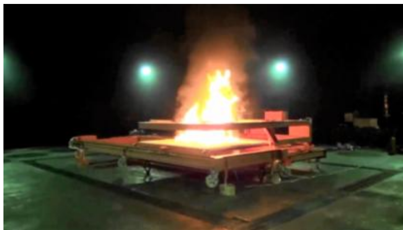
図 29 蓄電池耐火性試験
