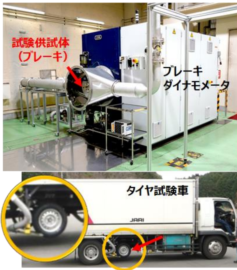
図13 ブレーキ摩耗粉塵測定用（上）およびタイヤ摩耗粉塵測定用（下）の機器
