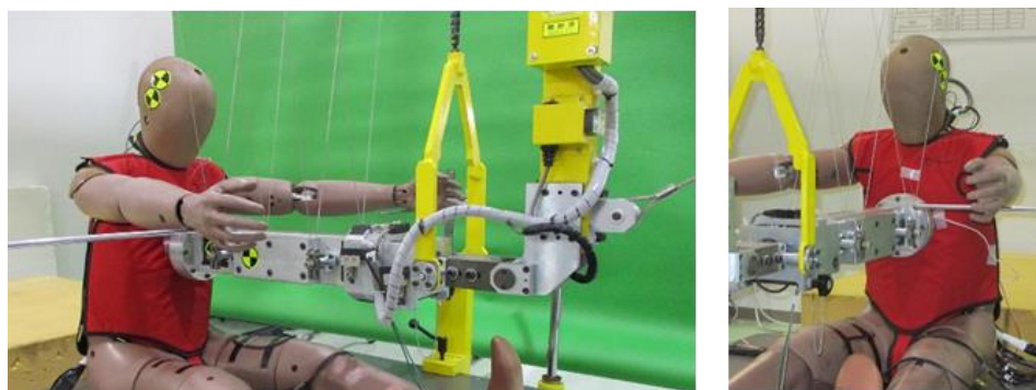
図35 前面衝突用ダミーTHOR-50Mの胸部インパクト試験
