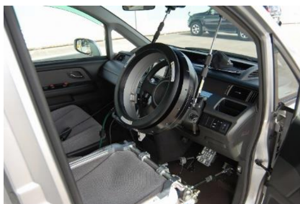
図46 運転操作ロボット
