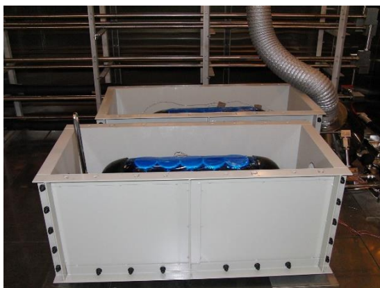
図26 大型恒温槽を用いた液圧サイクル試験
