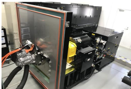
図23 モータダイナモメータ（400kW）
