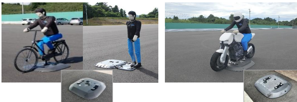
図44 自律走行型ターゲット装置（VRU用）
