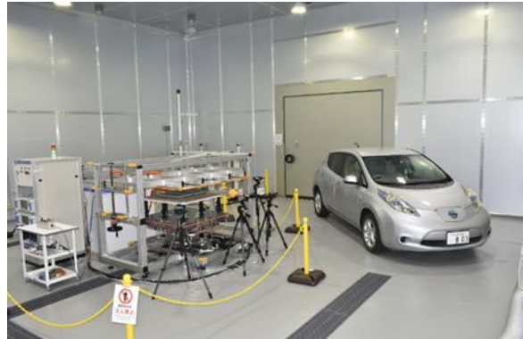
図5 ワイヤレス給電ユニット評価装置とシールドルーム
