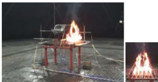
図15 火炎暴露試験法の適正化に向けた試験
