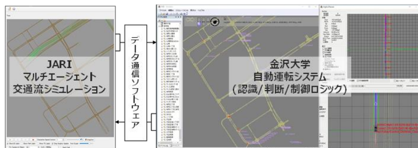
図37 マルチエージェント交通流シミュレーションと自動運転システムを接続した仮想評価環境
