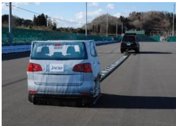
図42 車両 (CCRm) ターゲット装置
