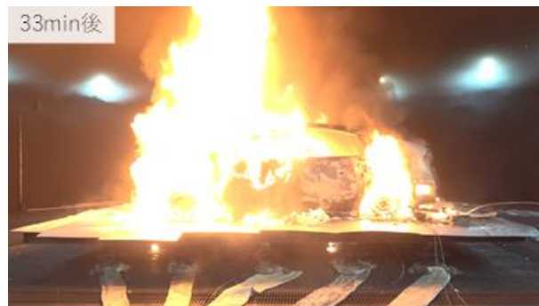
図18 車両火災時の発熱速度計測
