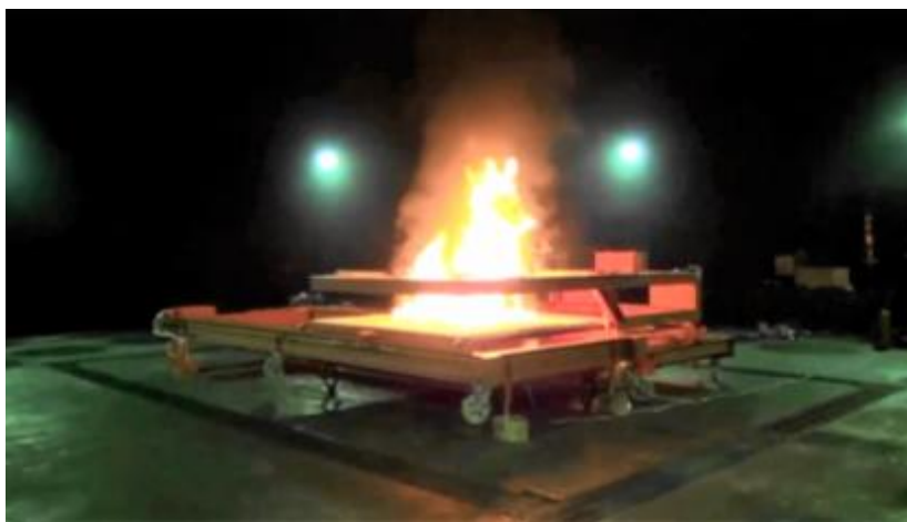
図28 蓄電池耐火性試験
