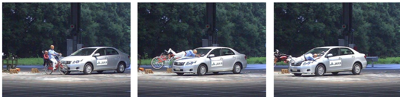
図34 自動車対自転車の衝突実験
