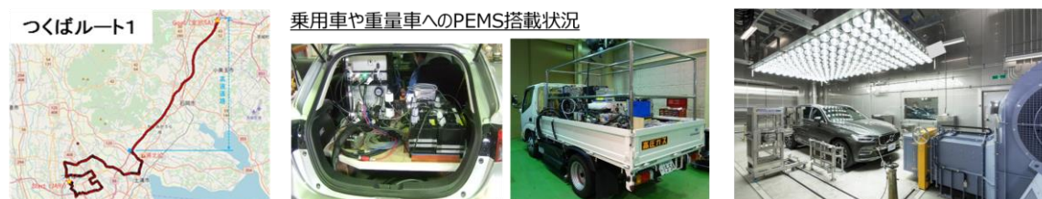
図8 RDE試験時の走行ルートとPEMS積載状況、環境型C/Dを活用したRDE評価方法の研究
