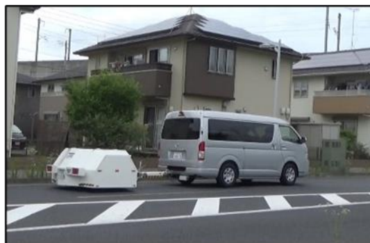
図7 騒音測定用CPXトレーラ
