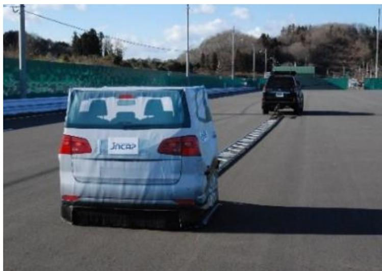
図42 車両(CCRm)ターゲット装置
