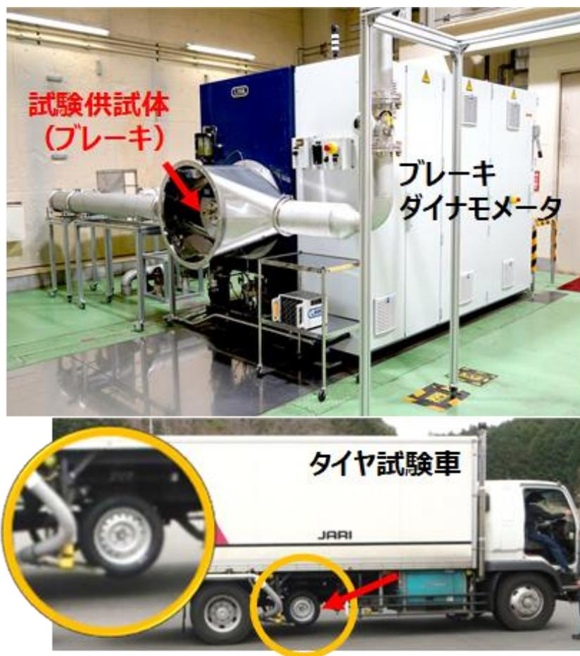
図13 ブレーキ摩耗粉塵測定用（上）およびタイヤ摩耗粉塵測定用（下）の機器
