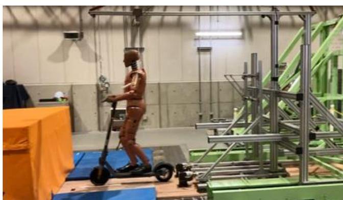
図52 例. 運転電動キックボードの衝突試験
