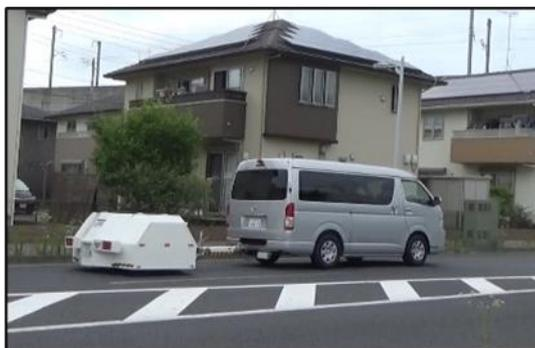
図7 騒音測定用CPXトレーラ
