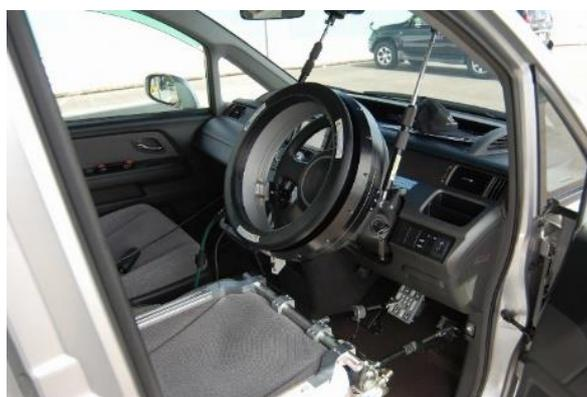
図46 運転操作ロボット
