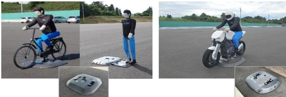
図44 自律走行型ターゲット装置（VRU用）
