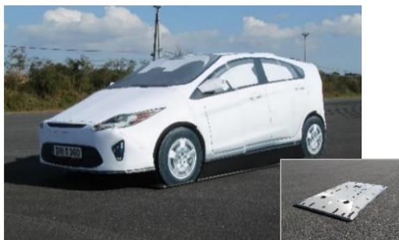
図45 自律走行型ターゲット装置（車両用）
