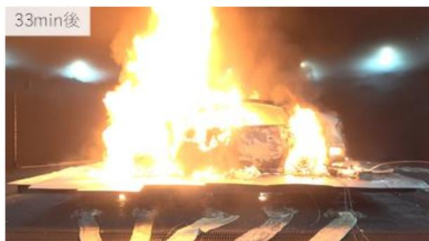
図18 車両火災時の発熱速度計測
