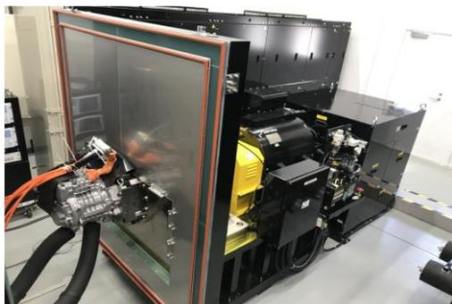
図23 モータダイナモメータ（400kW）
