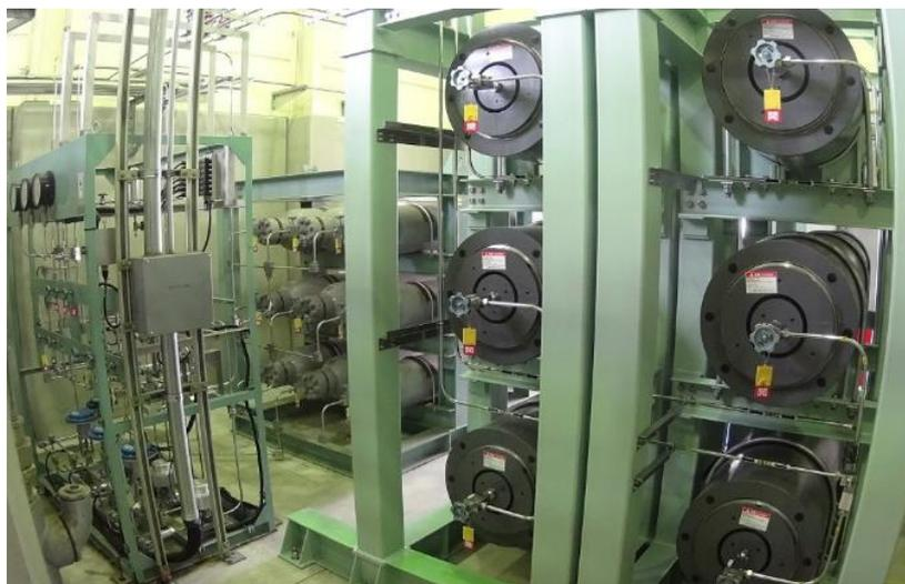
図27 圧縮水素試験設備の蓄圧容器
