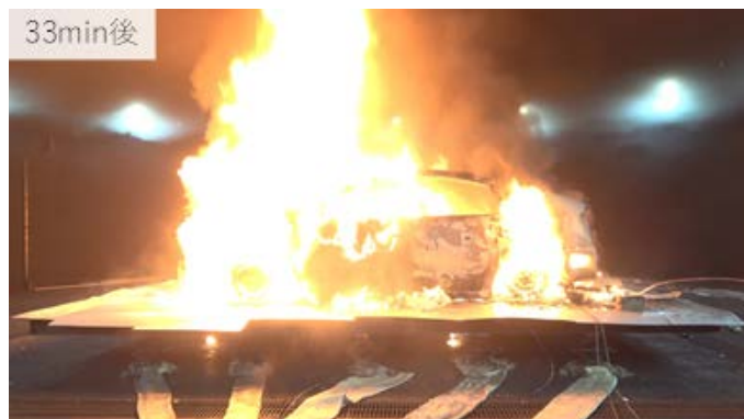
図 17 車両火災時の発熱速度計測
