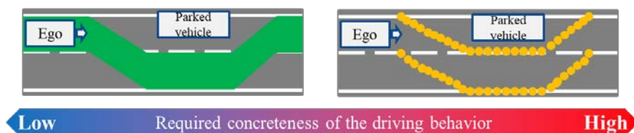
図 36 目標とする走行ラインに対する許容偏差の厳格さを示す視覚情報の例
