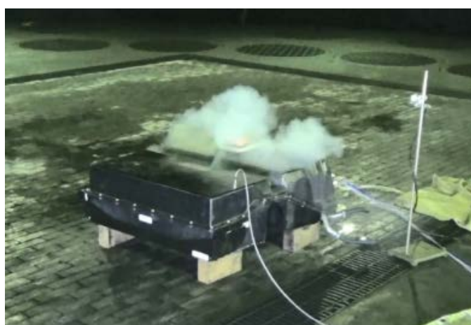
図 16 車載用電池パックによる熱連鎖試験
