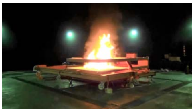
図27 蓄電池耐火性試験
