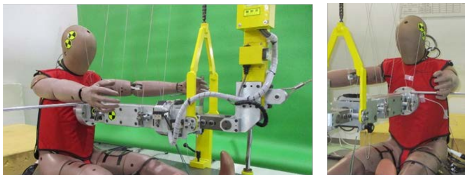
図 34 前面衝突用ダミーTHOR-50Mの胸部インパクト試験
