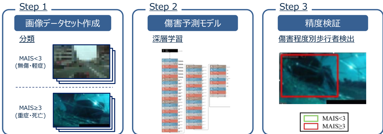
図 32 深層学習手法を用いた歩行者の傷害予測モデルの構築
