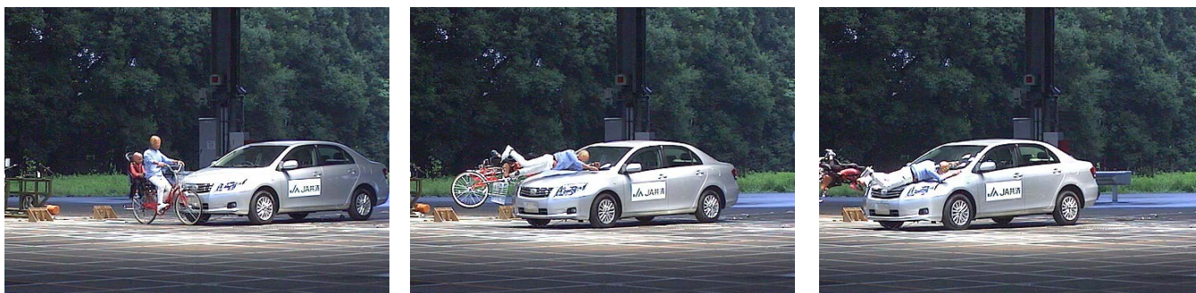
図 33 自動車対自転車の衝突実験
