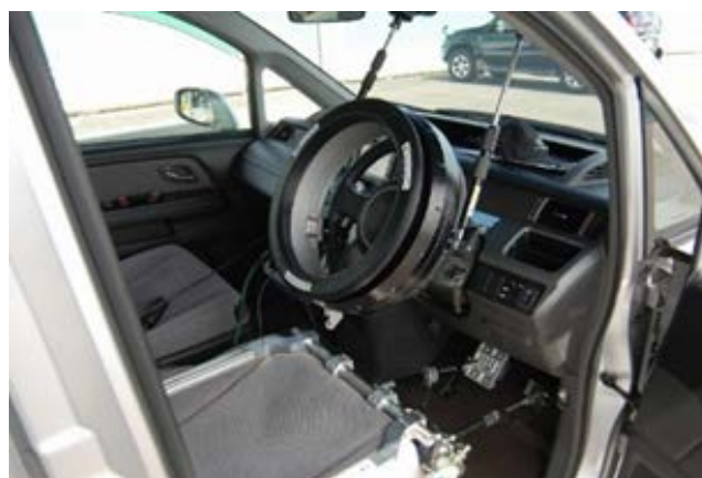
図 45 運転操作ロボット
