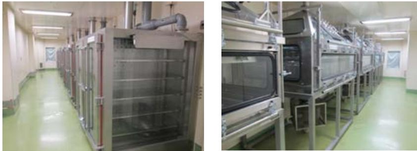
図 13 自動車排出ガス吸入曝露装置
