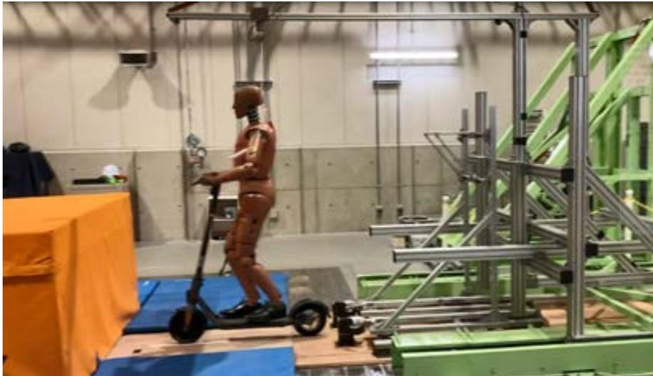
図 51 例 運転電動キックボードの衝突試験
