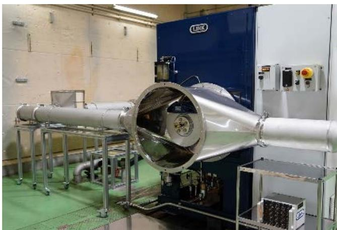
図 21 ブレーキ摩耗粉塵試験装置
