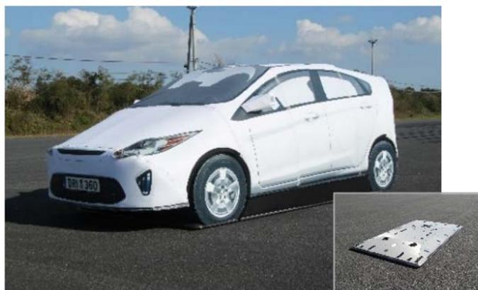
図 44 自律走行型ターゲット装置（車両用）
