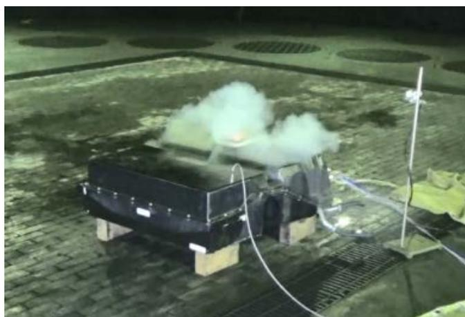
図 16 車載用電池パックによる熱連鎖試験
