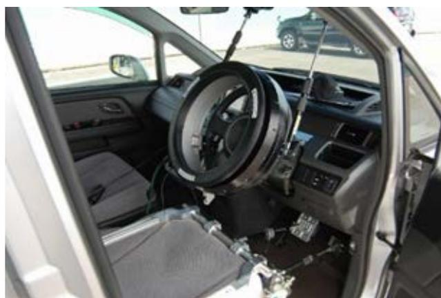
図 45 運転操作ロボット
