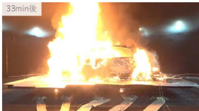
図 17 車両火災時の発熱速度計測
