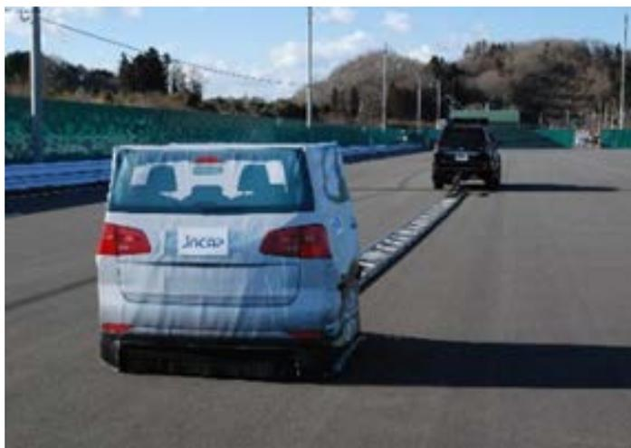
図 41 車両（CCRm）ターゲット装置
