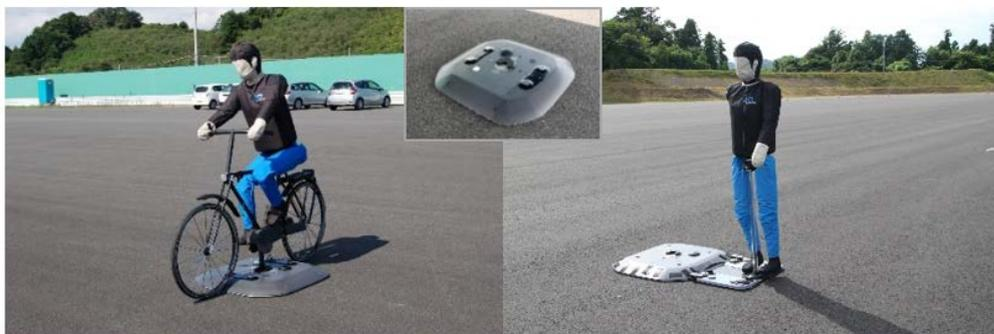
図 43 自律走行型ターゲット移動装置（VRU 用）
