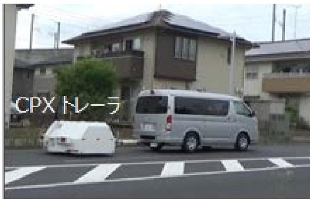
図 11 道路交通騒音シミュレーションの例と騒音測定用CPXトレーラ
