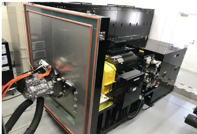
図 22 モータダイナモメータ（400kW）
