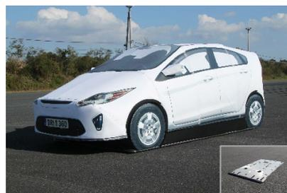
図 51 自律走行型 車両ターゲット装置
