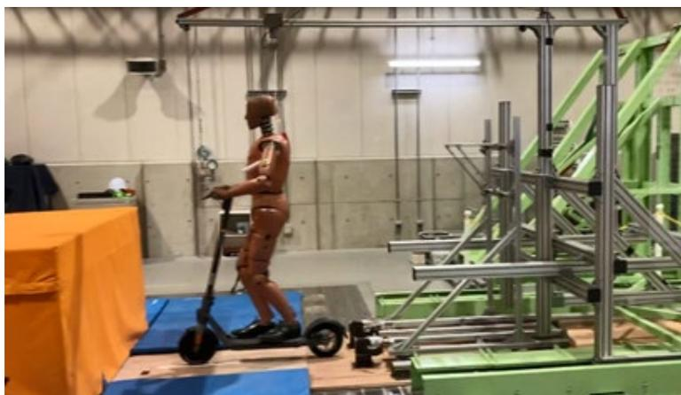
図 59 例. 運転電動キックボードの衝突試験
