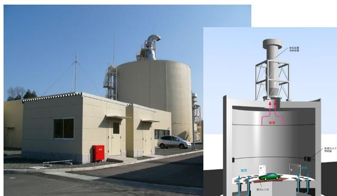
図 24 耐爆火災試験設備
