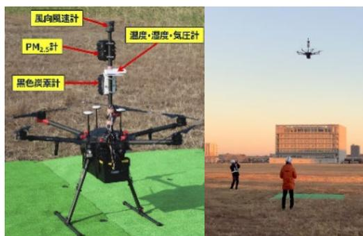
図 12 ドローンによる大気環境計測
