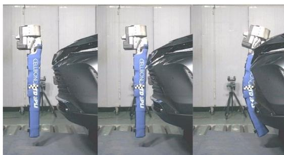
図 34 先進脚部インパクト（a-PLI）による歩行者脚部保護性能評価試験
