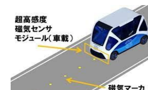
電磁誘導線/磁気マーカ
